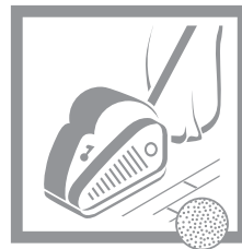
4 Schleifen Grobschliff Körnung 80-100
