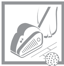
2 Schleifen Grobschliff Körnung 60
