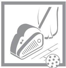
1 Schleifen Grobschliff Körnung 40
